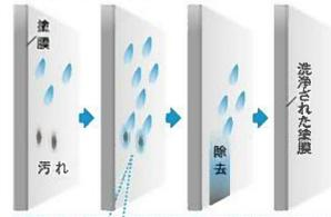
高親水性により外壁の汚れと雨水が一体化
